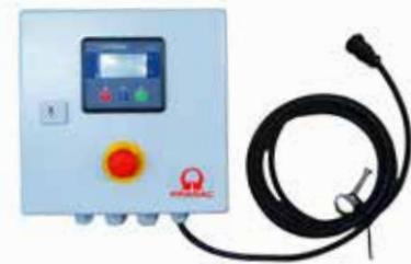
Die AMF Notstromautomatik schaltet bei Netzausfall den Stromerzeuger automatisch zu, somit können wichtige Verbraucher (z. Bsp. Heizung, Kühltruhe etc.) weiterhin mit Strom versorgt werden
