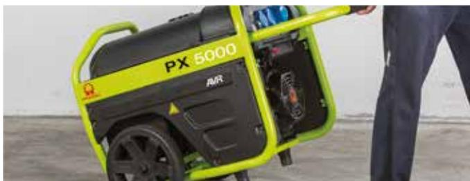
PX Stromerzeuger sind sofort einsetzbar. Alle Modelle sind mit Radsatz und Transportbügel komplett montiert ausgerüstet. Es müssen nur noch die Betriebsstoffe eingefüllt werden.
