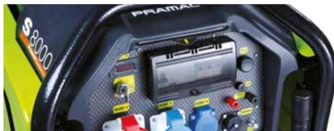
Il nuovo quadro elettrico è stato dotato di una presa addizionale, di un display digitale con frequenzimetro, voltmetro e contaore, di un CONNettore per le versioni elettriche e della protezione differenziale o isometer come opzione.
